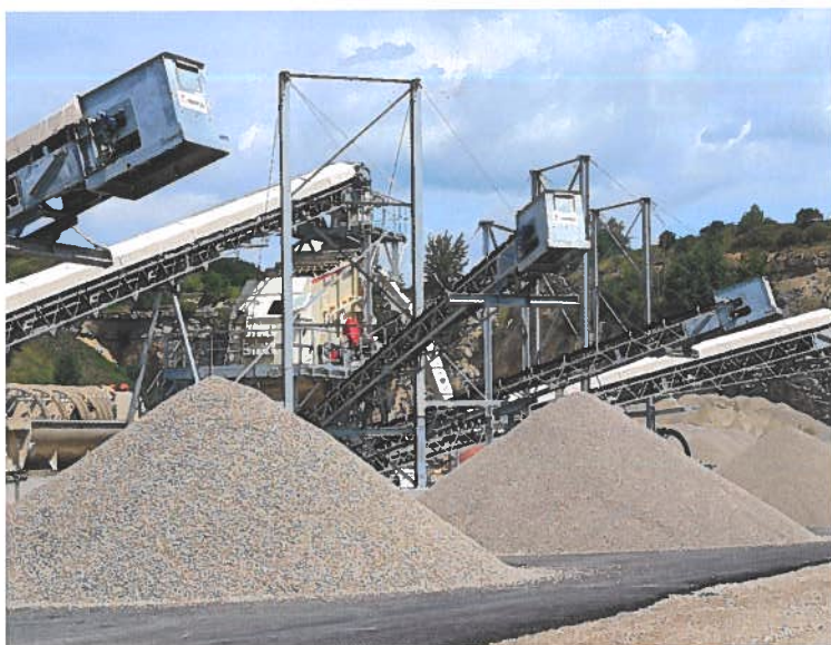
Mit dem 2-Deck Premier Kreisschwingsieb CVB202 und dem 3-Deck Premier Kreisschwingsieb CVB203 werden mehrere Fraktionen erzeugt.
